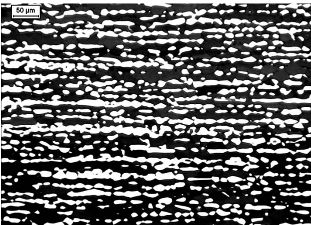
Figura 3. Microscopia óptica da secção longitudinal de uma amostra solubilizada do material após ataque metalográfico com reativo de Behara modificado, mostrando ferrita (escura) e austenita (branca).
