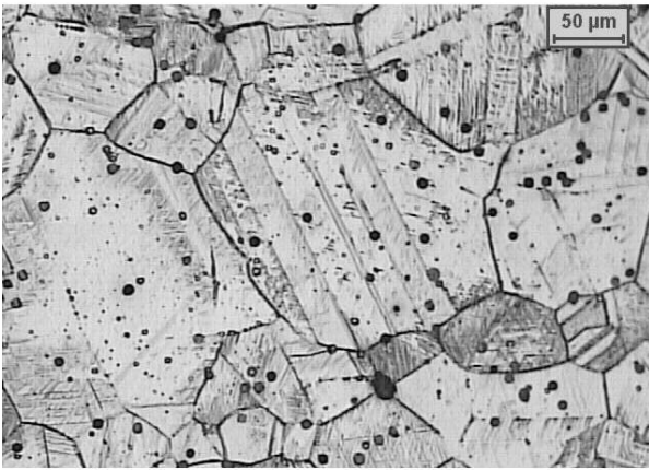
Figura 3. Microestruturas típicas da liga B obtidas para regiões centrais das amostras submetidas a um tempo de austenitização de 2400s em diferentes temperaturas de austenitização: (a) 850°C; (b) 900°C; (c) 950°C; (d) 1050°C.
