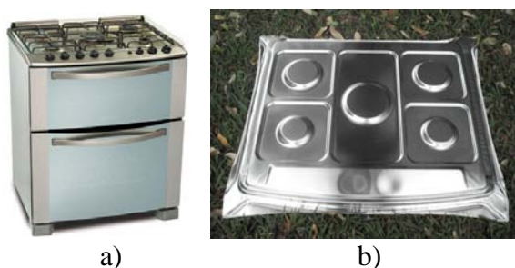
Figura 1 – a) Fogão de alto padrão Electrolux – duplo forno, todo em inox. b) Mesa de fogão em aço 439, logo após a primeira etapa de estampagem – cliente Whirlpool.
