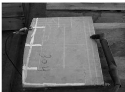
Figura 1 – Disposição da traçagem dos corpos-de-prova sentido de laminação da chapa (longitudinal e transversal).
