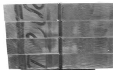
Figura 3 – Quatro corpos-de-prova aço inoxidável austenítico, com entalhe de charpy tipo A sem o processo de soldagem.
