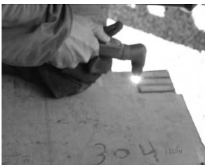
Figura 2 – Maçariqueiro executando o corte dos corpos-de-prova AISI 304.
