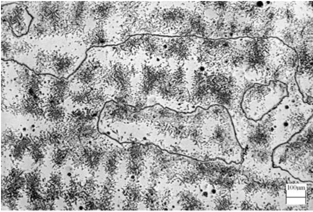
Figura 3: microscopia ótica - amostra envelhecida por 48 horas a 900 °C – ataque com água régia.
