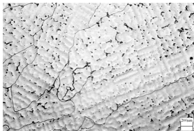
Figura 2: microscopia ótica - amostra envelhecida por 1,5 hora a 900 °C – ataque com água régia
